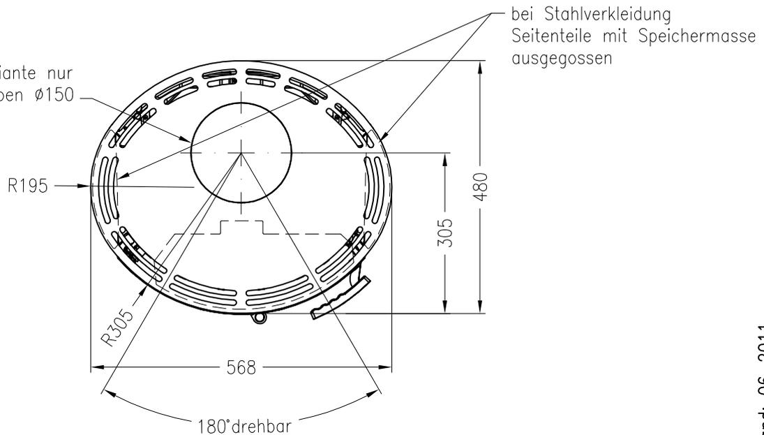
Drehbare Variante nur mit Abgang oben und Zulufstutzen unten möglich!
